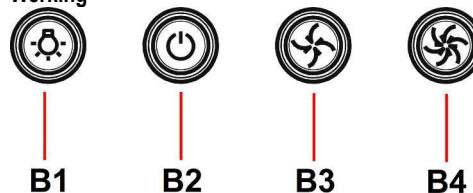
De kap is voorzien van een bedieningspaneel met een schakelaar voor de snelheid van afzuiging en een schakelaar voor de verlichting van het fornuis.
