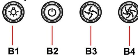
Napa je opremljena s komando ploščo z nastavljivo hitrosti izsesavanja in nastavljivo jakosti svetlobe za osvetjevanje kuhalne plošče.
