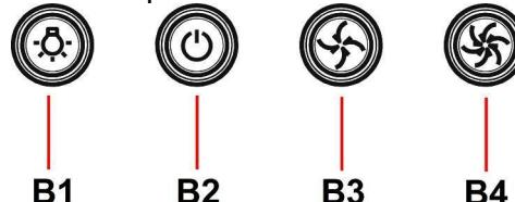
Okap jest wyposażony w panel sterowania z regulacją prędkości turbiny zasysającej oraz własnikiem oświetlenia przestrzeni roboczej pod okapem.
