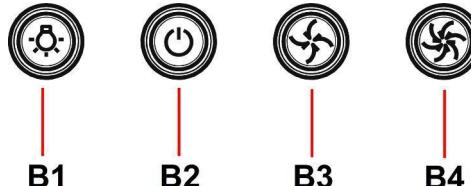
O exaustor vem equipado com um painel de comandos com um controlo de velocidade de aspiração e um controlo para acender a luz de iluminação do plano de cozedura.
