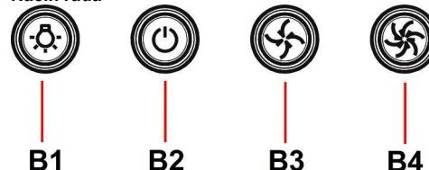
Aspirator je opremljen komandnom tablom koja podešava brzinu usisavanja i kontroliše uključivanje svetala da bi se osvetlila površina za kuhanje.
