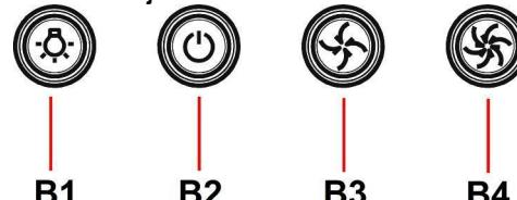
Napa ima upravljačku ploču s kontrolom brzine usisavanja i kontrolom paljenja svjetla za osvjetljenje površine za kuhanje.
