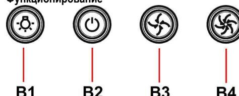
Вытяжка оснащена панелью управления для контроля скорости вытяжного вентилятора и включения света для освещения рабочей поверхности плиты.
