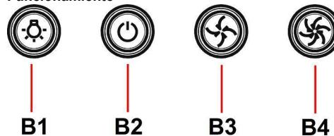
La campana está dotada de un panel de mandos con control de las velocidades de aspiración y control de encendido de la luz para la iluminación del plano de cocción.
