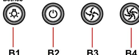
Die Dunstabzugshaube ist mit einer Bedienungsblende ausgestattet, die mit einer Steuerung für die Ansaugstärke bzw. -geschwindigkeit, sowie einer Steuerung zur Einstellung der Arbeitsplatzbeleuchtung versehen ist.
