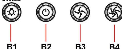
Odsávač pary je vybavený ovládacím panelom s kontrolou odsávacej rýchlosťi a s kontrolou zapínania svietidla na osvetlenie varnej pracovnej plochy.
